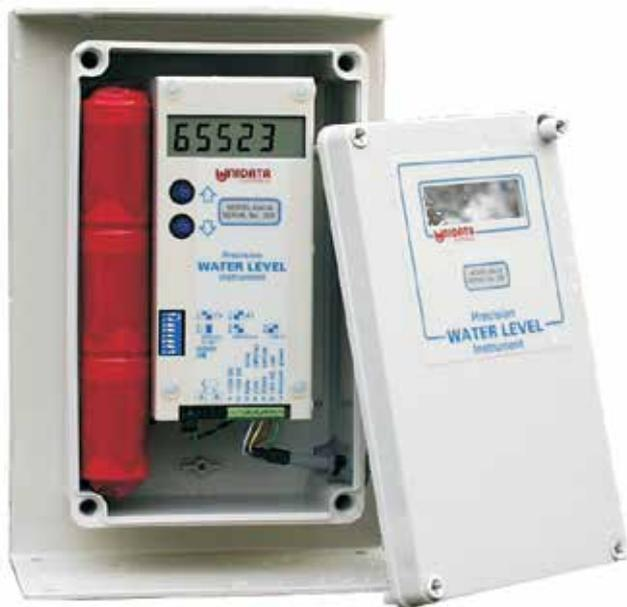
El instrumento de nivel de agua de precisión modelo 6541 puede lograr una precisión de funcionamiento y resolución de 0.2 mm. Esta precisión se mantiene durante la vida útil del instrumento sin calibración o mantenimiento, aparte de los cambios de la batería.
