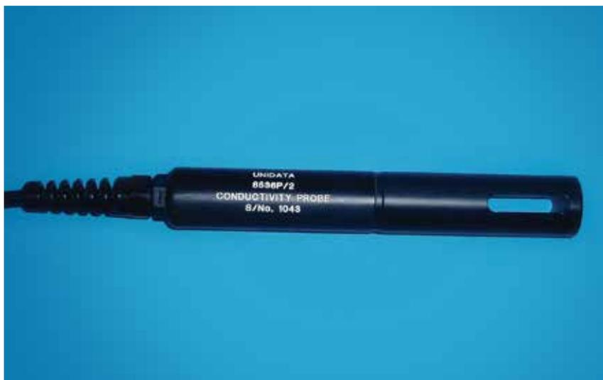
Esta sonda está diseñada para utilizarlo con el Instrumento de electroconductividad de agua 6536D.
