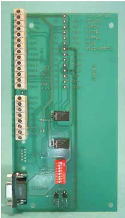
La Bornera de Terminación Starflow modelo 6103K está diseñada para simplificar la instalación de un sistema Starflow. Provee lo siguiente:
