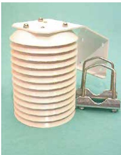
Esta pantalla de radiación de enmalle proporciona un buen escudo contra los efectos de la precipitación y la radiación directa, y las partículas de polvo. Los sensores de temperatura y humedad ambiental pueden fácilmente instalarse dentro. Una abrazadera universal en U permite el montaje en poste de forma horizontal o vertical.
