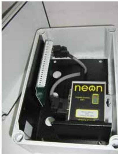
La serie 2701 de pequeñas cajas resistentes a la intemperie se puede utilizar para alojar terminales remotos Neon 2001B y 2011C para aplicaciones de campo.
