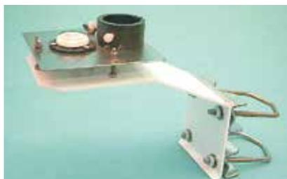
Este conjunto de montaje consiste en una unidad de nivelación, equipada con una bola de 30 mm de diámetro, un brazo de montaje y hardware de montaje para los postes de diámetro máximo de 60 mm. Los sensores deben ser ópticamente estabilizados para las mediciones repetidas.
