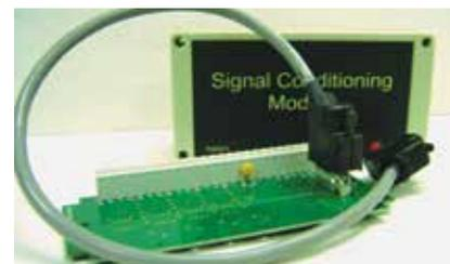
Esta es una bornera de terminación de campo extendida utilizado con los terminales remotos Neon.
