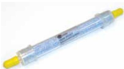
Para mantener el tubo de ventilación seco en el cable venteado, se conecta al cable un tubo de secado que contiene "gel de sílice" desecante. El tubo de secado necesita ventilarse a la atmósfera.
