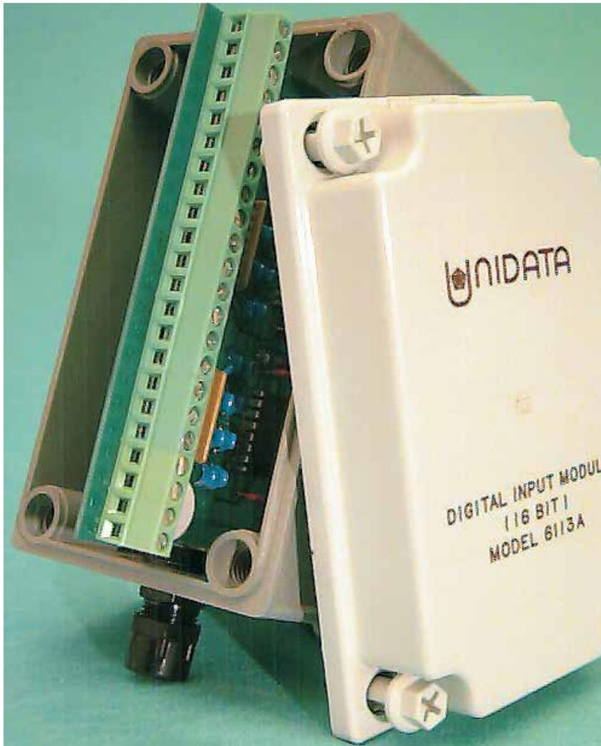
El módulo de entrada digital se utiliza para registrar el estado de los contactos eléctricos (por ejemplo, para el estado on/off de la bomba o el registro del evento).
