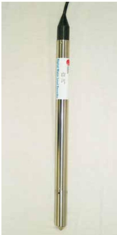
El Registrador Digital de Nivel de Agua 8007DWLR es una mejora del registrador de profundidad de agua Micrologger 8007B. Puede medir profundidades de agua de 10 a 50 metros en los rangos normales.
