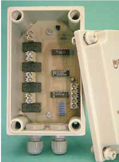
El módulo de control de relé de 4 canales es una interfaz diseñada para permitir que el registrador de datos controle cuatro relés a cierre magnético.
