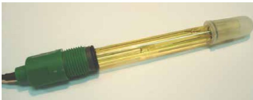
Estas sondas de doble juntura tienen un diseño robusto y una carcasa de cuerpo epóxico llena de un gel de amortiguación no rellenable. Se utiliza un sistema de juntura de referencia doble para minimizar los efectos de la contaminación debido a los poros tapados o ingreso de la muestra. Se encuentran diseñados como un instrumentos de bajo consumo, e incluyen un sistema electrónico de acondicionamiento para la conexión directa a un Registrador de Datos.
