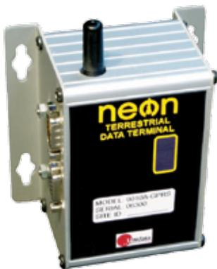
El terminal remoto NEON (NRT) Terrestre 2001C es una pequeña unidad autónoma que se conecta a sensores en el campo, recolecta las lecturas de los sensores y transmite los datos obtenidos a un servidor central a través de una red de telefonía celular.
