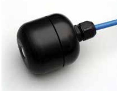
La sonda de oxígeno disuelto es un elemento de medición galvánica que produce una salida de milivoltios proporcional al oxígeno presente en el medio en el cual se coloca. Se compone de una parte superior con el cátodo, el ánodo y el cable, y una tapa con membrana y el electrolito.
