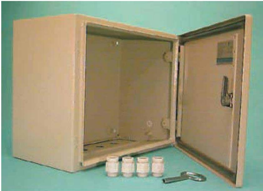
Esta caja de acero gris de ancho doble alberga en un solo recinto el registrador de datos, la bornera de terminación de campo, el marco de montaje y los equipos adicionales. Se suministra la placa de montaje del equipo, pernos y una llave especial.
